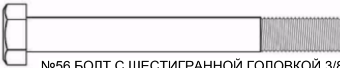
№56 БОЛТ С ШЕСТИГРАННОЙ ГОЛОВКОЙ 3/8" X 3 1/4" ЧАСТИЧНАЯ РЕЗЬБА КОЛ-ВО 2
