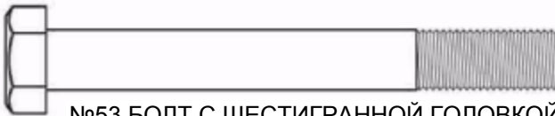
№53 БОЛТ С ШЕСТИГРАННОЙ ГОЛОВКОЙ 3/8" X 3" ЧАСТИЧНАЯ РЕЗЬБА КОЛ-ВО 7
