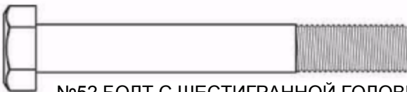
№52 БОЛТ С ШЕСТИГРАННОЙ ГОЛОВКОЙ 3/8" X 2 3/4" ЧАСТИЧНАЯ РЕЗЬБА КОЛ-ВО 4
