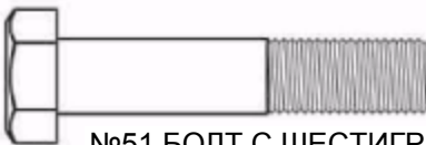
№51 БОЛТ С ШЕСТИГРАННОЙ ГОЛОВКОЙ 3/8" X 1 3/4" ЧАСТИЧНАЯ РЕЗЬБА КОЛ-ВО 22
